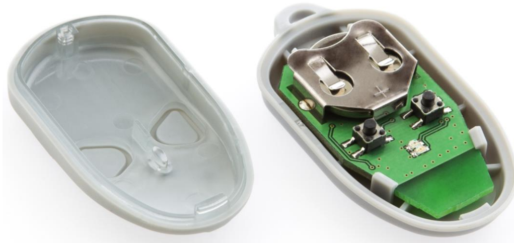
Рисунок 2. Идентификатор со снятой крышкой. Видна батарея питания
