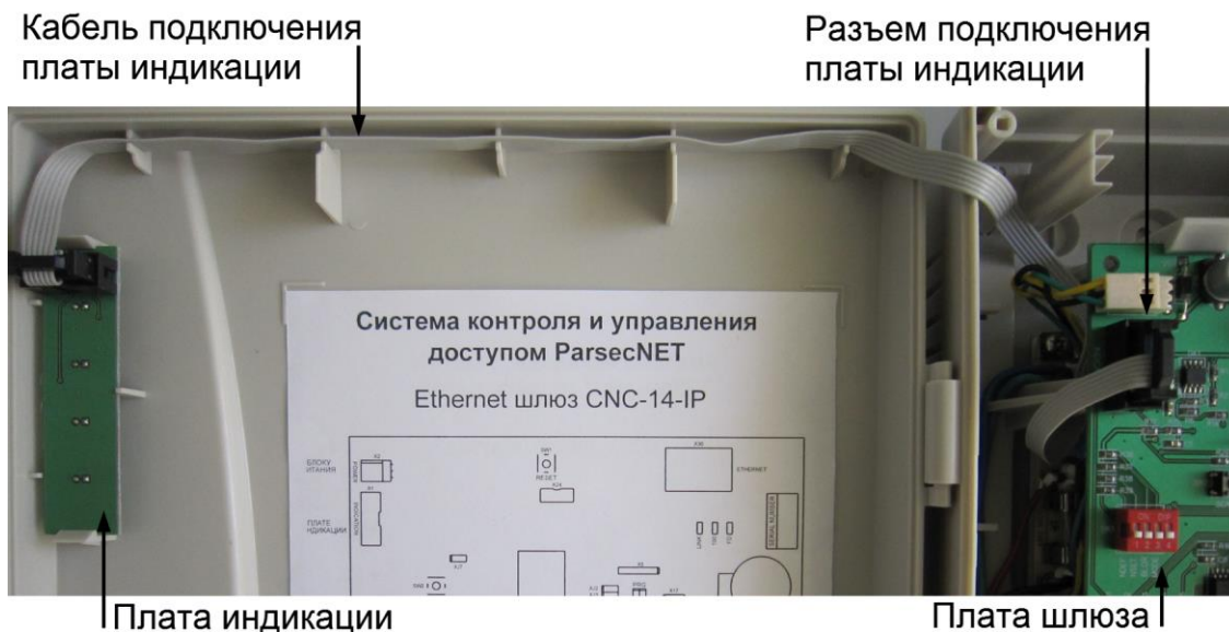
Рисунок 11. Подключение платы индикации
