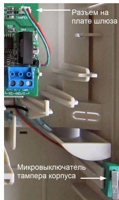
Рисунок 13. Подключение тампера корпуса
