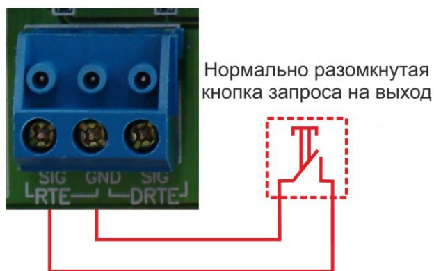
Рисунок 17. Подключение кнопки запроса на выход
