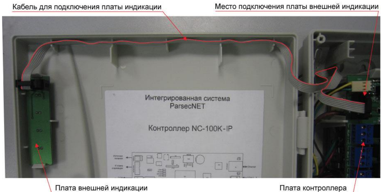
Рисунок 25. Схема подключения платы индикации
