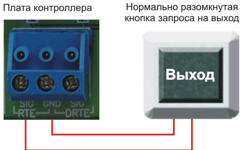
Рисунок 9. Схема подключения кнопки запроса на выход.
