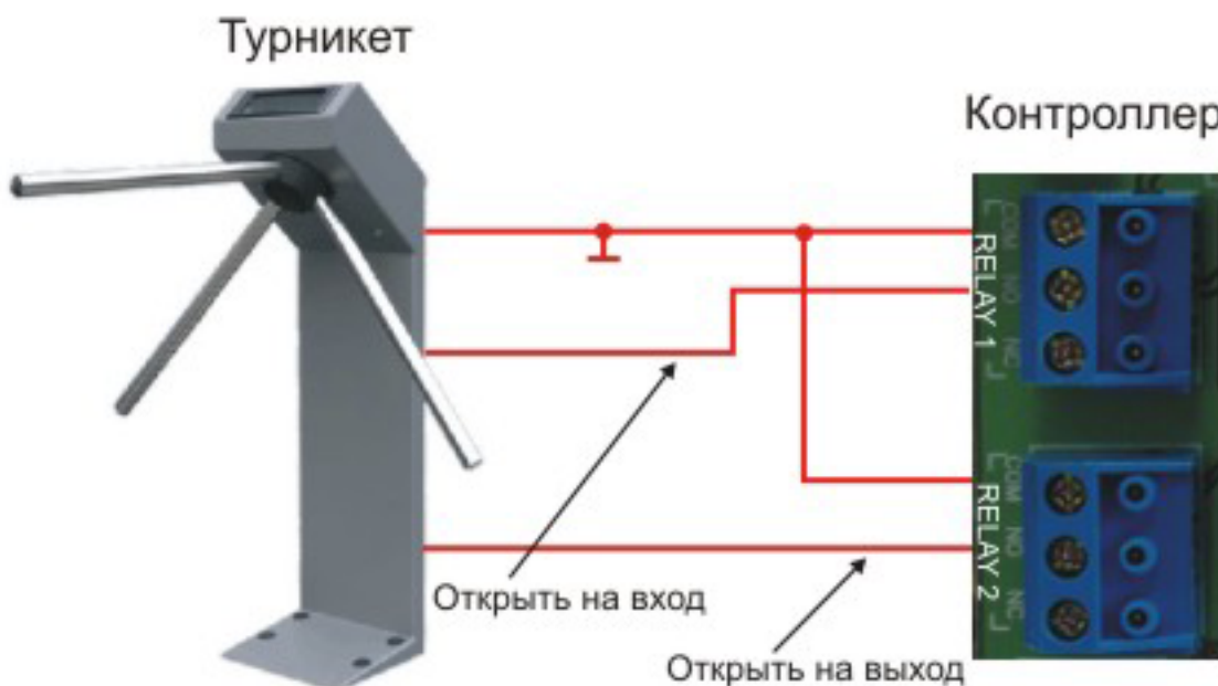
Рисунок 14. Управление турникетом контроллерами.
