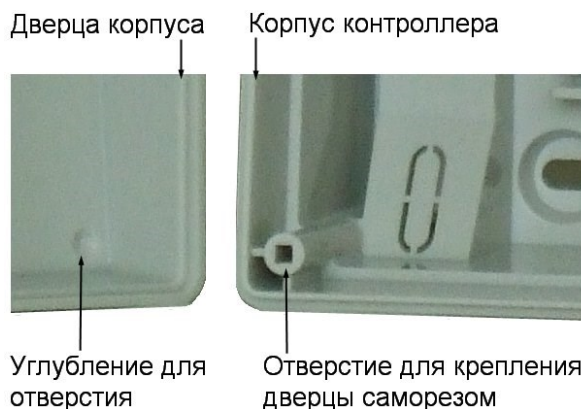
Рисунок 5. Схема «жесткого» крепления дверцы к корпусу контроллера
