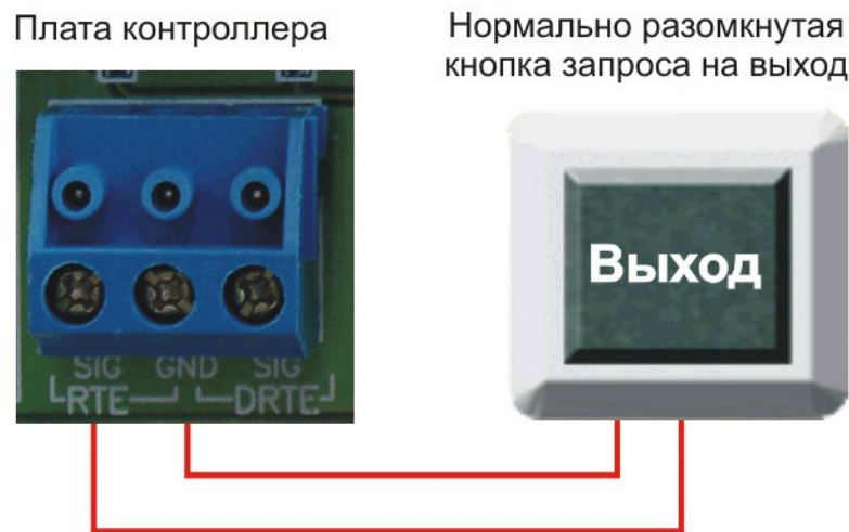
Рисунок 16. Схема подключения кнопки запроса на выход
