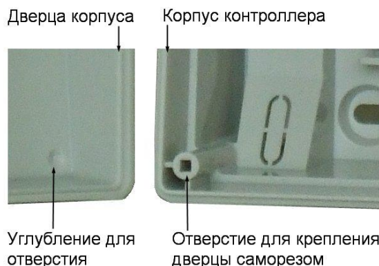
Рисунок 5. Схема «жесткого» крепления дверцы к корпусу контроллера
