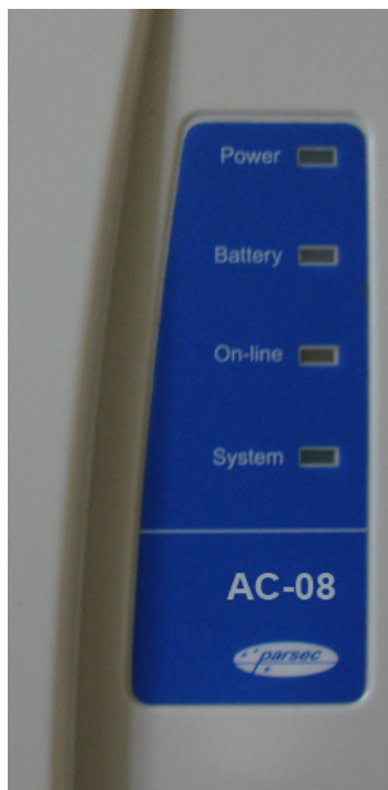
Рисунок 12. Внешняя индикация состояний контроллера.
