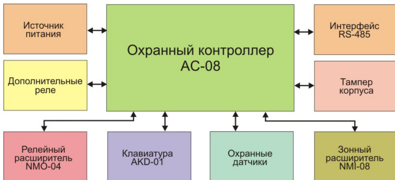
Рисунок 7. Оборудование, подключаемое к контроллерам АС-08.
