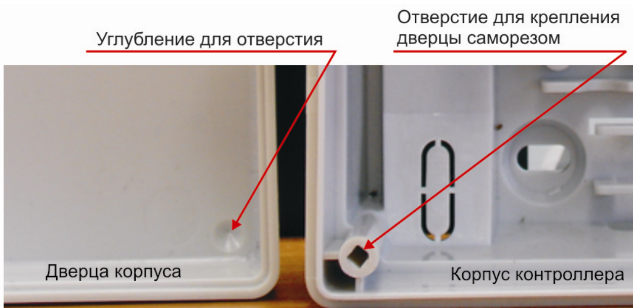
Рисунок 3. Схема «жесткого» крепления дверцы к корпусу контроллера.
