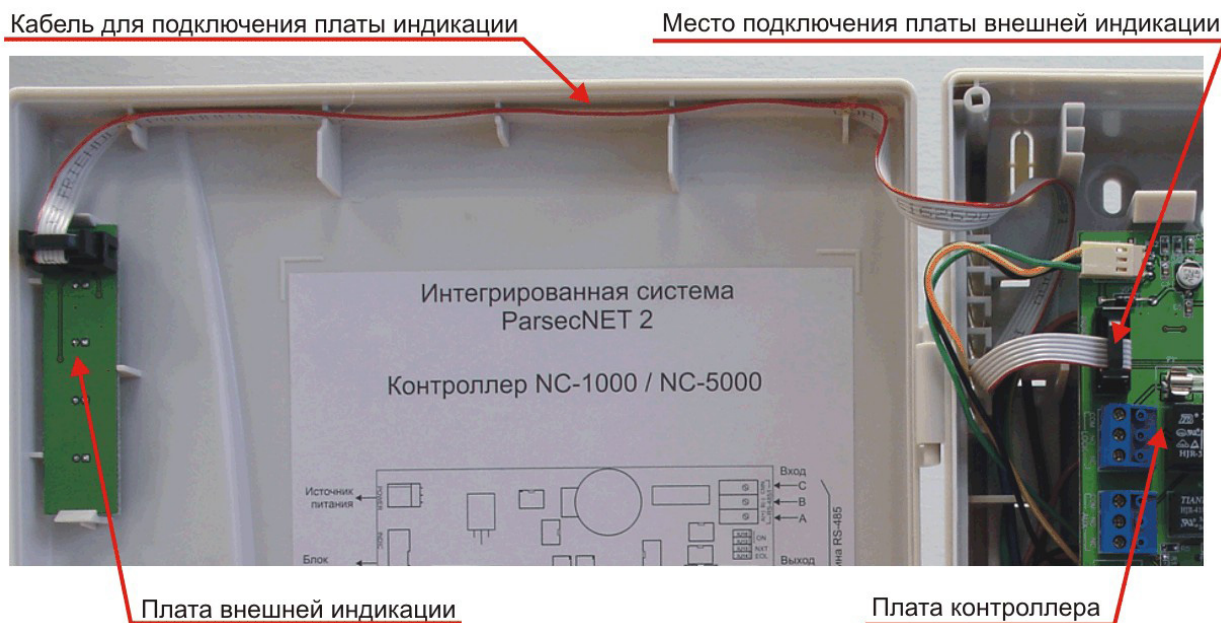
Рисунок 21. Схема подключения платы внешней индикации.
